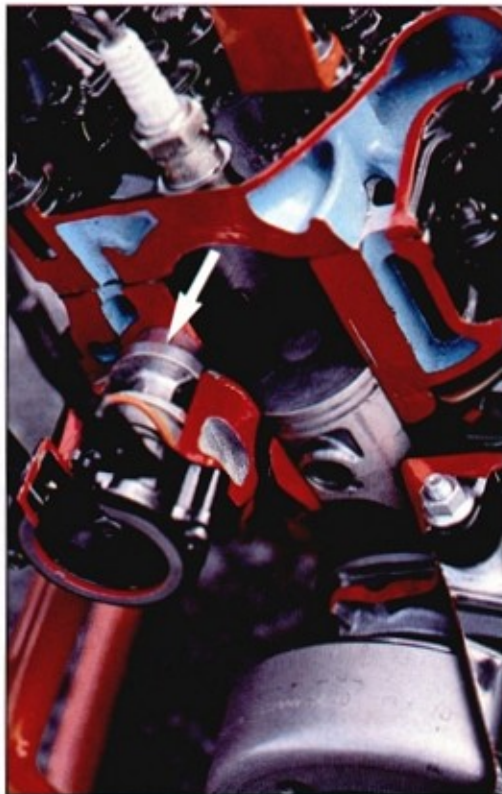
Links: Das Schnittmodell zeigt die Lage der Power Valve-Steuerwalze vor dem Auslaßschlitz. Unten: Zylinderkopf ①, Zylinder ②, Kolben ③, Steuerwalzen ④, Einlaßmembran ⑤ und Kühlwasserthermostat ⑥
