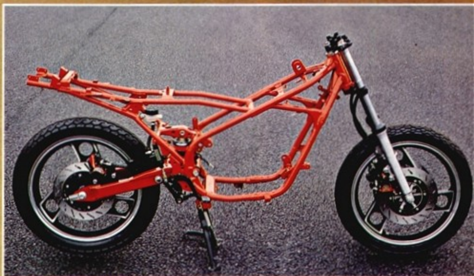
Breit geführter, stabiler Doppelschleifen-Rohrrahmen, Monoshock-Hinter- radfederung mit progressi- ver Charakteristik
